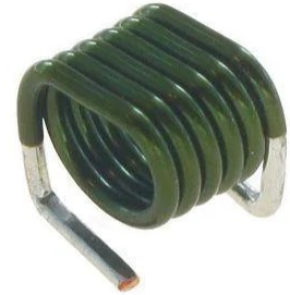
270nH luchtkern van coilcraft 800 MHz SRF, 4.3 A saturatie
