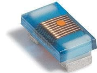
8.2nH draadgewonden van coilcraft 5.9 GHz SRF, 1.4 A saturatie
